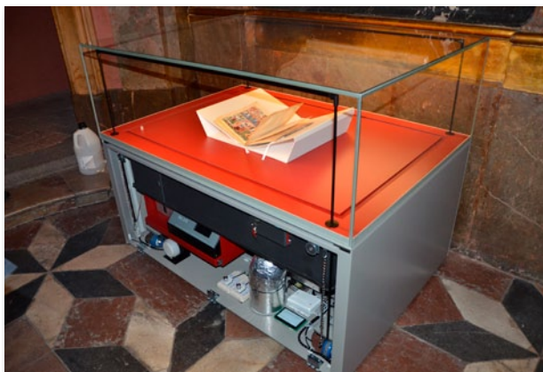
Obr. č. 1: Regule T a RV a adjustace knihy. Foto: P. Vávrová.
