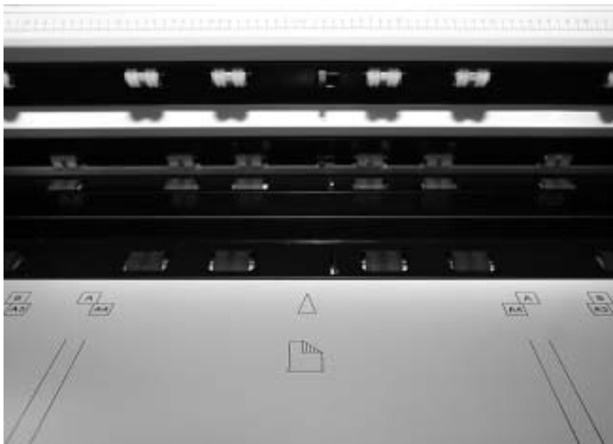
Průchodový skener Contex Crystal XL 42" posouvá skenovaný předmět pomocí gumových válečků.
