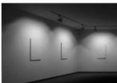
Světlomety a lištové systémy – široko vyzařující světlomety – osvětlení exponátů vč. jejich okolí
