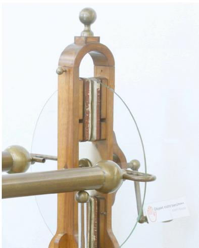
Bei der oben abgebildeten Elektrisiermaschine reibt Leder an Glas. Schau genau! Wo sind im Bild das Leder, das Glas und die Kurbel? Beschrifte!
