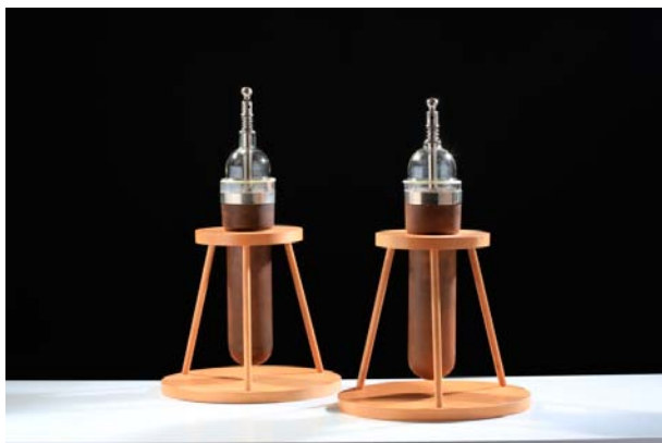
Obr. 9: Model leydenské lahve ze sbírky NTM od firmy Schott & Gen. v německé Jeně (inv. č. 22 063). Tato pomůcka, která dokázala produkovat elektrickou energii a uchovávat ji pro pozdější využití, se vyskytovala ve mnoha fyzikálně-chemických kabinetech škol. Foto Kateřina Uksová.
