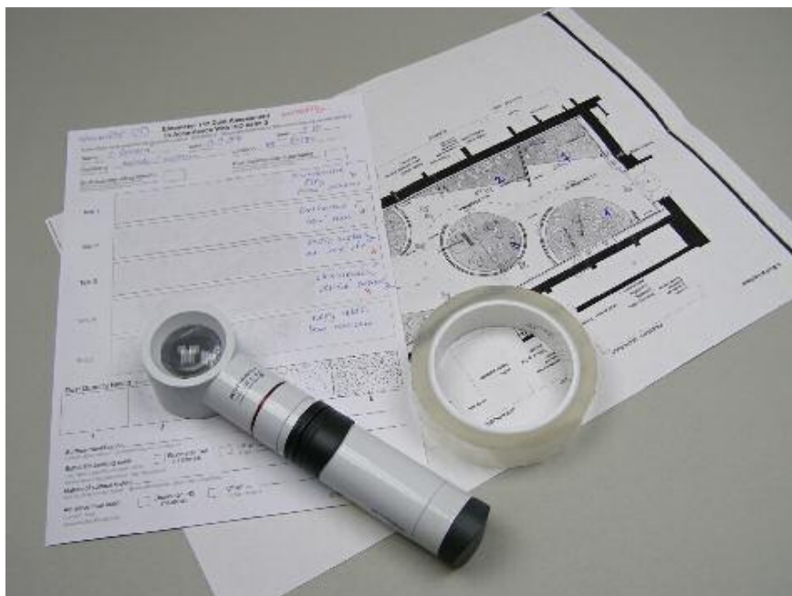
Obr. 5: Použití Dust Tape Test Kit pro sbírání vzorků ve výstavě Retro. Foto: V. Šulcová.
