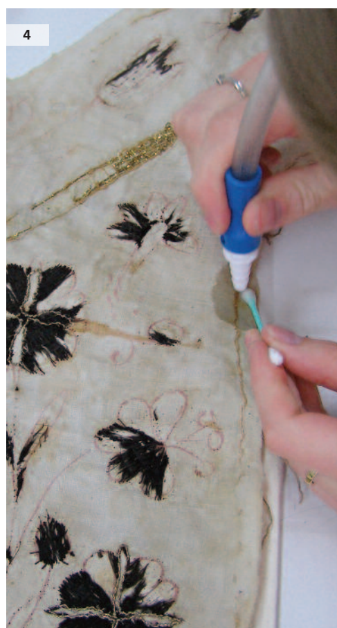
Obr. 3: Test pomocí bathofenanthrolinu na zjištění přítomnosti Fe^{2+} na vzorku hedvábné příže. Foto: D. Fagová, 2015.
