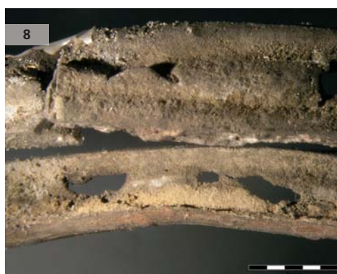
Obr. 8: Detail proděravěného jádra olověného H-profilu.
