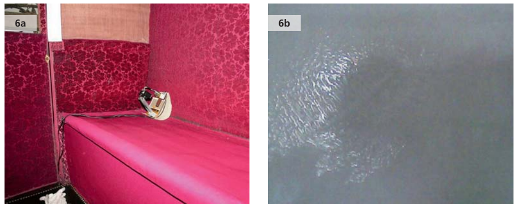
Obr. 6: Modul pro kontinuální on-line monitoring detekce přítomnosti polétavého hmyzu a) umístění senzoru, b) ukázka on-line fotografie z průběhu měření (přítomnost polétavého hmyzu neprokázána).
